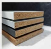
使用するパーティクルボードの素材は、木材の小片やチップです。チップを加熱・圧縮して板状に製造しているため、天然の木材とは違い、自由な大きさと厚みの板を作ることができるのが特徴です。また建物の解体時に出る廃材なども再利用されているため、資源の有効利用にも一役かっているサステナブルな建材とも言えます。
