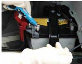
電気自動車専用の直流検電器
