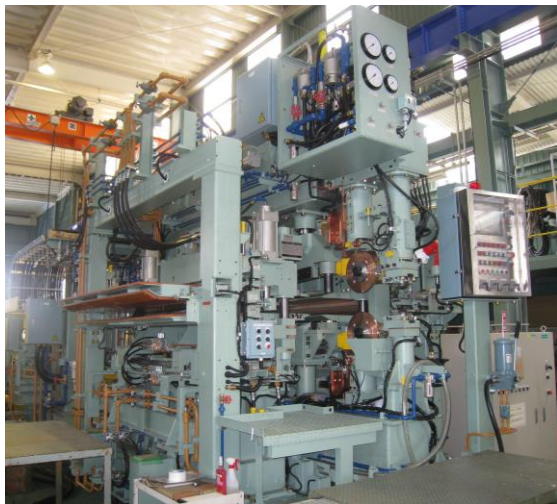
機器名 鉄鋼ライン向け マッシュシーム溶接機 製作期間 2011年3月～2011年6月
