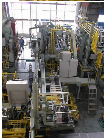
機器名 鉄鋼ライン向け フラッシュバット溶接機 製作期間 1989年6月～現在に至る
