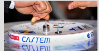
土俵：φ250mm／凹R700mm ケミカルウッド製
